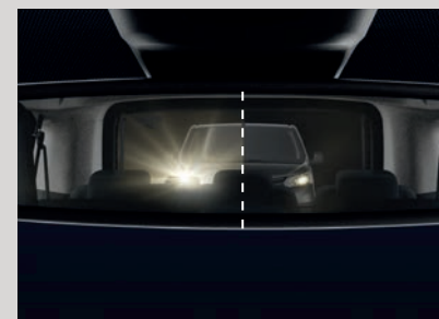
Rétroviseur intérieur anti-éblouissement (partie droite) vs normal.
