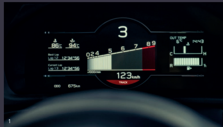
1 / Passez en mode TRACK et l'écran affiche le régime moteur, le rapport, la vitesse et les températures de l'huile et de l'eau.
